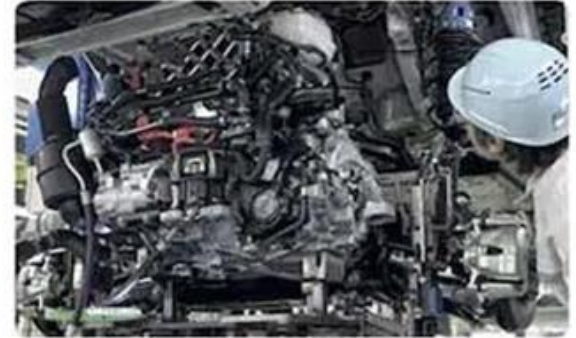
Montaż sterownika mocy wraz z silnikiem elektrycznym na wysokości przedniej osi Mirai
